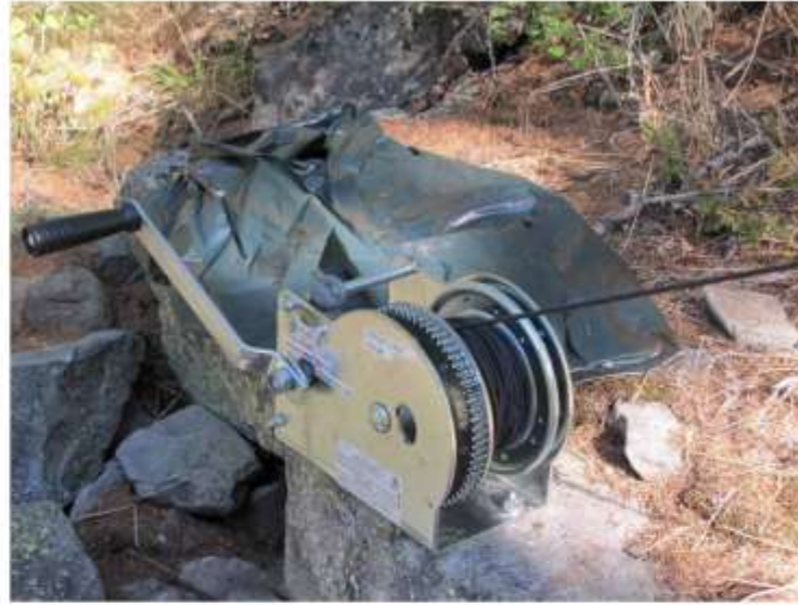
Vue générale (panneau et antenne) et detail du treuil annexe pour les operations de montée et descente
