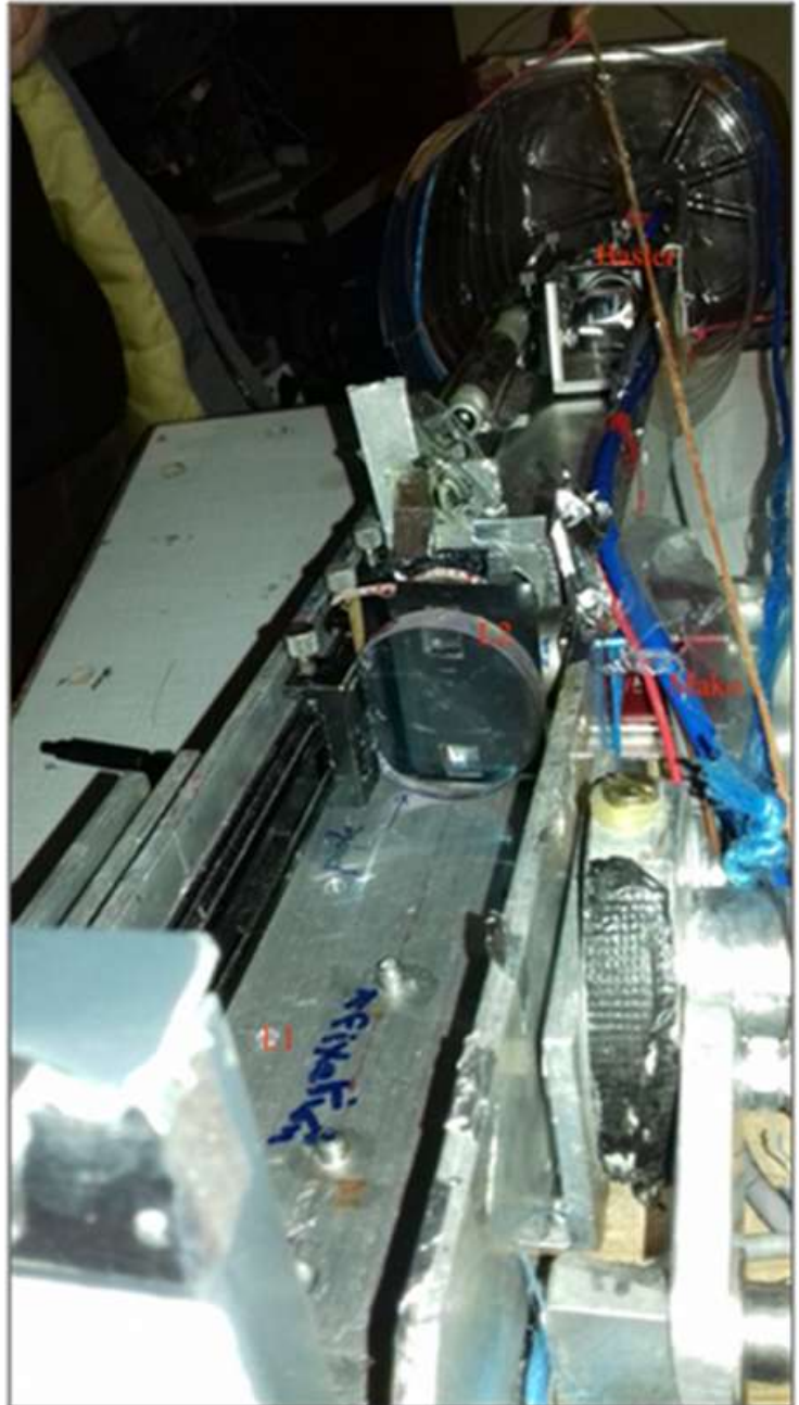
Figure 9. Position (en rouge) des caméras Mako et Basler dans la nacelle
