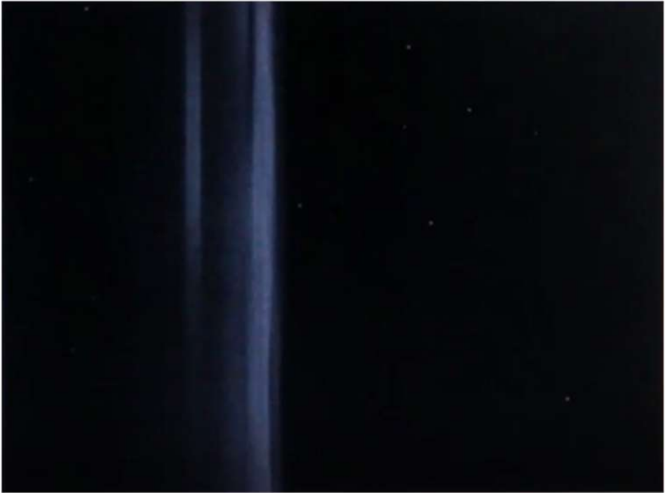
Figure 10. Image captée le 09/09/2019 par la caméra Basler de la nacelle. La raie de droite, disparaissant lorsqu'on éteint la LED du miroir M1, lui est attribuable. Celle de gauche semble attribuable à Véga, mais sa faible largeur est encore mal comprise
