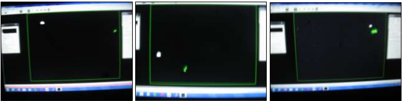
Figure 26 Vega et laser vert dans Viseur Nord, le laser se déplace dans le viseur avec le positionnement du miroir
