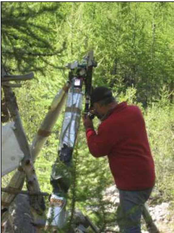
Figure 30 Le viseur mi base "-30", réglé lors d'une nuit précédente, permet de positionner la nacelle au point de démarrage du suivi
