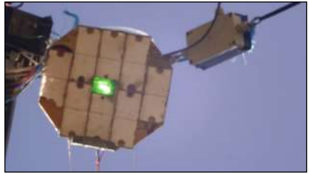
Figure 41 On oriente la nacelle pour que le laser vert illumine le miroir Nord
