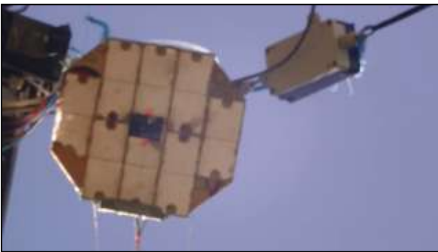
Figure 42 LED rouges autour du trou d'entrée de la nacelle
