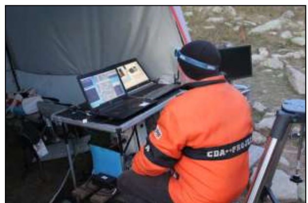
Figure 32 Les deux ordinateurs de pilotage de l'opération et de visualisation des caméras de la nacelle. A l'extérieur, le moniteur de visualisation de la caméra du viseur Nord
