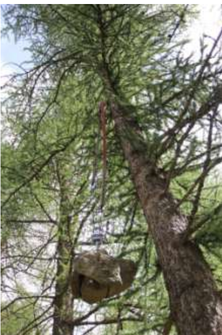
Le contrepoids Ouest et sa chaîne qui permet d'en modifier la masse au cours du mouvement de la nacelle
