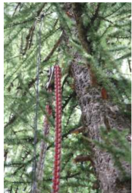
Le contrepoids Ouest et sa chaîne qui permet d'en modifier la masse au cours du mouvement de la nacelle
