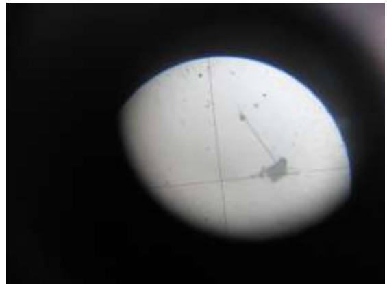
Positionnement de la nacelle à -30' à l'aide du viseur mi base
