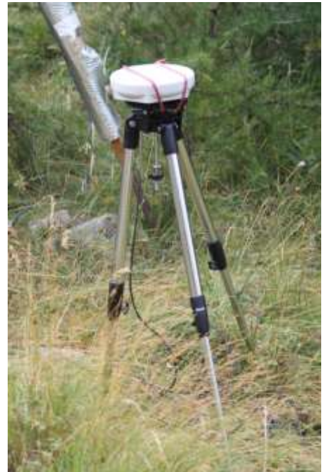
L'antenne WiFi pour communication avec la nacelle
